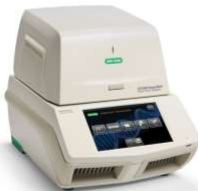
Сурет 1- Нақта уақыттағы ПТР жүргізуге қолданылған анализатор
